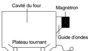
Dans un four à micro-ondes, l'électricité est convertie en micro-ondes par le **MAGNÉTRON**.
