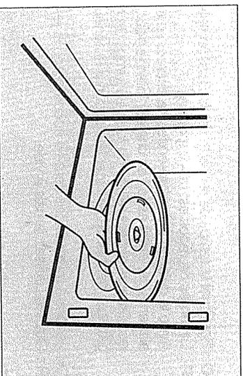
7 L'anneau de guidage et la paroi intérieure du four doivent être nettoyés régulièrement pour éviter une rotation trop bruyante du plateau. Nettoyer simplement le bas de la cavité avec un produit de nettoyage doux ou avec du lave-vitre et sécher. L'anneau de guidage doit être lavé à l'eau et au savon.
