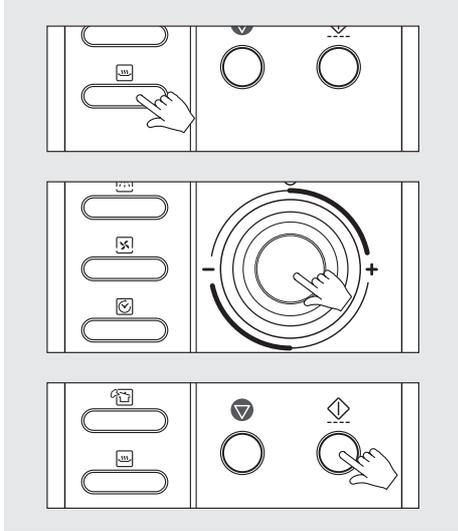
1. Appuyez sur le bouton **Maintien au chaud** (la température est réglée environ à 60°C).
